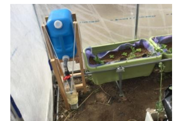
▲灯油タンク給水装置
