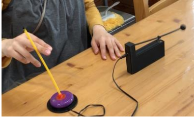
（写真1）アタッチメントを装着し、より弱い力で押せるようにしたスイッチで、ソレノイドで駆動する自作打楽器装置を操作できるようにした例。
