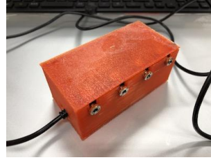
（写真2）外部スイッチでシンセサイザーが演奏できる自作インターフェイス。
