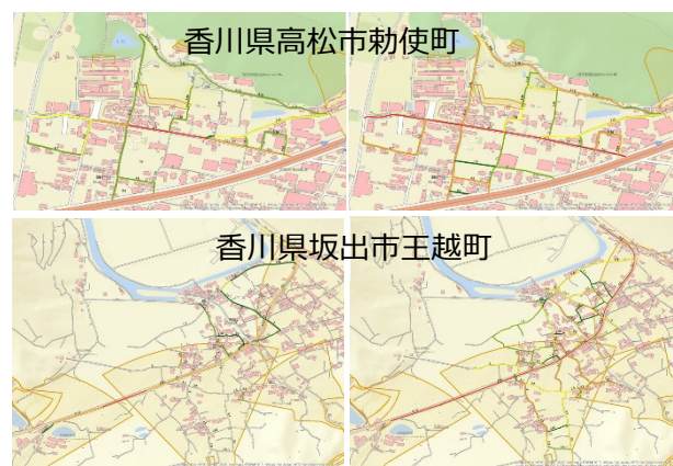
図-3. GISに取り纏めた調査結果 左図: 車両交通量(高頻度:赤←→低頻度:緑) 右図: 道路幅(広い:赤←→狭い:緑)
