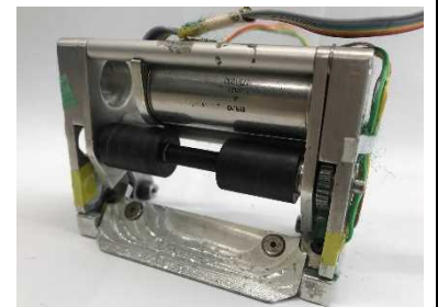
図 5 新ドリブルシステム(分割バー機構)
