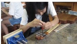
図4 弦を張る作業
